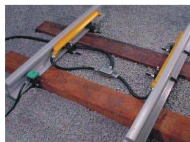
Instalação simulada mostrando o sensor de rodas e outros componentes do sistema de distribuição.
